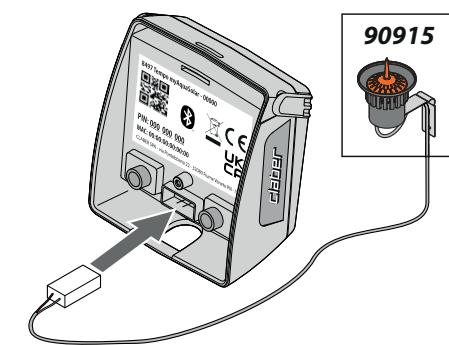
To Tempo myAquaSolar μπορεί να χρησιμοποιηθεί με τον αισθητήρα βροχής Claber Rain Sensor με καλώδιο (κωδ. 90915). Ο προγραμματιστής ελέγχει την κατάσταση του αισθητήρα: αν το δοχείο είναι γεμάτο (βροχομετρία τουλάχιστον 5 mm), το πότισμα δεν θα ξεκινήσει και το ενδεχόμενο πότισμα που είναι σε εκτέλεση θα διακοπεί μέσα σε 1 λεπτό. Το χειροκίνητο άνοιγμα της βαλβίδας, είτε από το πλήκτρο είτε από την εφαρμογή, ενεργοποιείται και με το Rain Sensor ενεργό.
